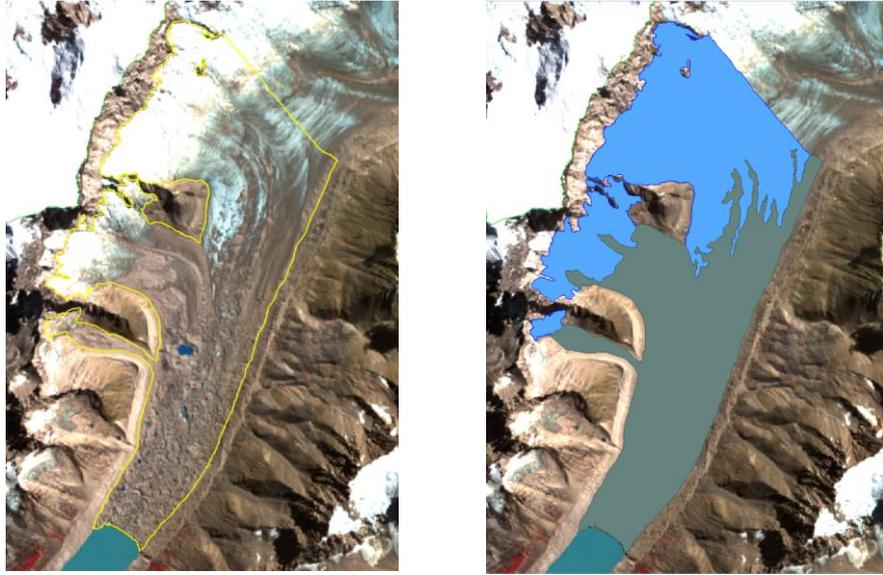
**Figura 5: Ejemplo de un glaciar visto en una imagen ASTER (izquierda, en amarillo). A la derecha puede observarse esta unidad con todas las subunidades que la componen, en celeste el hielo descubierto y en gris el hielo cubierto. Todas las subunidades tendrán el mismo código de identificación (ID).**
