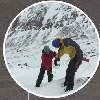
Instalación de balizas en el glaciar para medir ablación y acumulación de nieve/hielo
