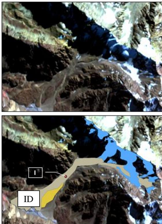
**Figura 6: Ejemplo de una unidad compuesta vista en un mosaico de imágenes ASTER (arriba), y con todas las subunidades que la componen digitalizadas (abajo). El punto rojo en el centro de la unidad se utilizó para obtener las coordenadas geográficas de la misma. Todas las subunidades tienen el mismo código de identificación (ID).**
